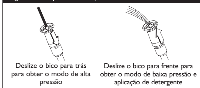
Figura 72 — Ajuste do Bico para Pressão
